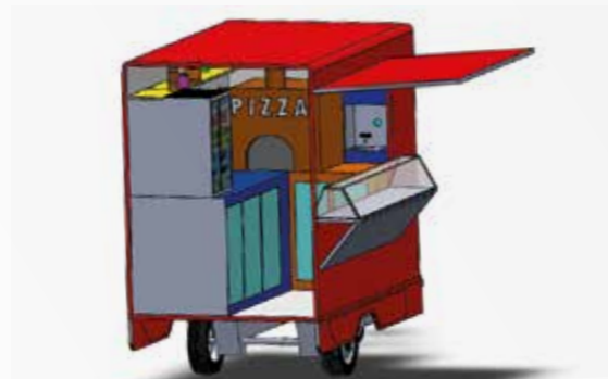
Box con forno a legna e accessori per lavoro interno Box with wood oven and accessories to work inside
